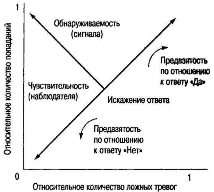
Рис. 2.7. Принципиальные особенности РХП Лежащая под углом 45^\circ диагональ искажения ответа соответствует случайному поведению наблюдателя, при котором количество попаданий равно количеству ложных тревог
